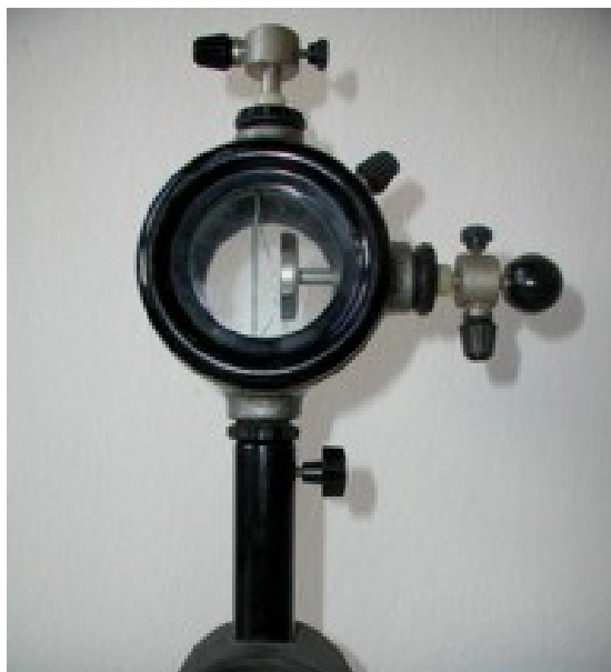
Figura 1: Una versione dell'elettroscopio di Wulf. Molti dei primi esperimenti sui raggi cosmici utilizzarono gli elettroscopi inventati da Wulf. Gockel, Hess, e Kohlhoester nelle loro ascensioni in pallone per misurare la dipendenza della radiazione cosmica in funzione dell'altezza, si servirono di tali dispositivi.
